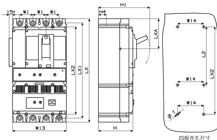
\* 为 RMM2L-100 欠压脱扣器接线端子尺寸
