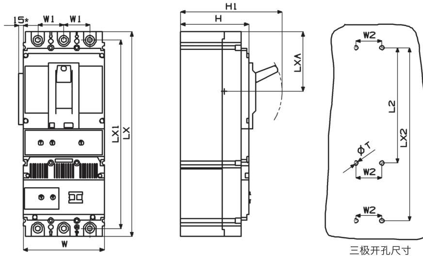
\* 为 RMM2L-100 欠压脱扣器接线端子尺寸
