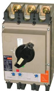
转动手柄操作机构可实现断路器的合闸、分闸和再扣。转动手柄还可在断开位置用挂锁锁定（挂锁用户自备）。
