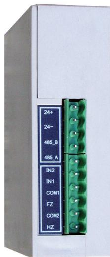
通讯模块上端面上的接线端子
